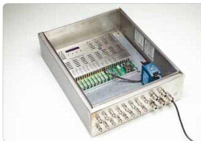
Obr. 4 Systém VDAU-6000 na monitorovanie technického stavu strojov prostredníctvom deskriptorov
