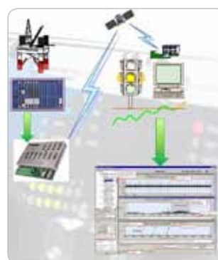
Obr. 5 Dialkový prenos deskriptorov z ťažko prístupného územia (vrtné plošiny a pod.)
