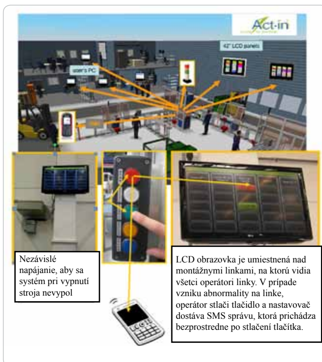
Obr. 3 Princíp funkčnosti systému ANDON v spoločnosti HELLA
