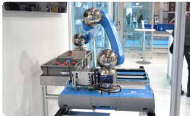
Obr. 7 Kolajový systém s autonómny robotom s nosnosťou 35 kg
